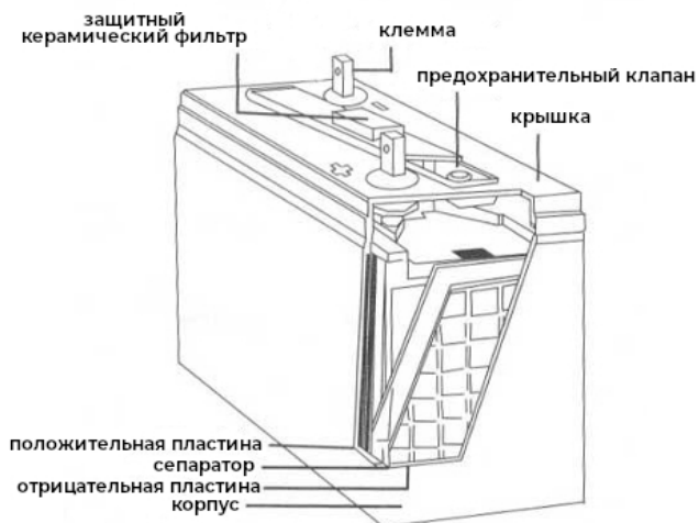
Рис. 1 Конструкция аккумуляторной батареи (серия 12В)
